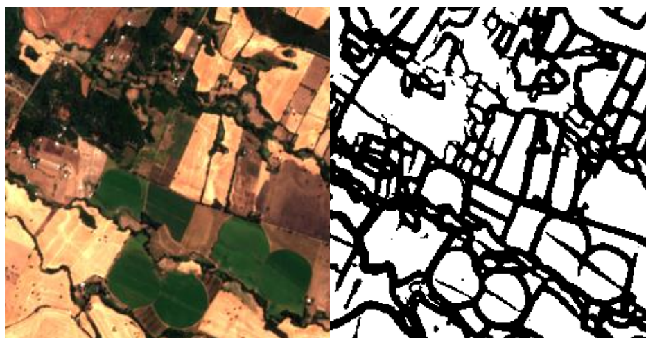
Figura 20a. Inferencia con el modelo ResUNet-a. La primera imagen es la entrada del modelo. La imagen derecha, es la máscara binaria resultante de binarizar las salidas del modelo.
